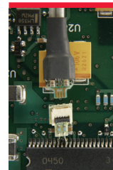
N5425B ZIFヘッド 予めハンダ付しておいた N5426A ZIFチップにつなぎ かえて使用
